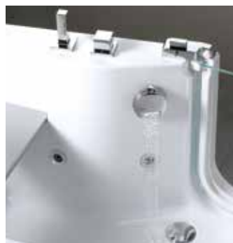
Wannenrandarmatur mit 2-Funktion Progressivmischer. Wanneneinlauf am Überlauf. Länge Handbrausenschlauch 60 cm und inkl. Handbrause 80cm Bei 3 Bar Wasserdruck 15 l/min beim Wanneneinlauf und 7 l/min bei der Handbrause
